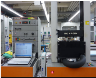
Prüfmaschine Instron 1251 im Prüfstand
