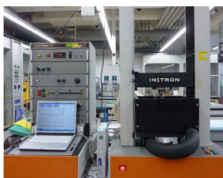
Machine de test Instron 1251 au banc d'essai
